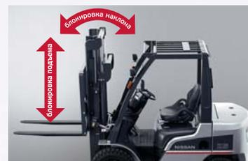
Данная система автоматически блокирует гидравлическую систему подъема и опускания груза при покидании водителем рабочего места. Система блокировки мачты входит в стандартную комплектацию погрузчиков NISSAN.
