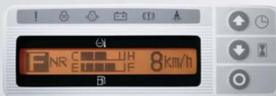
Многофункциональная приборная панель включает в себя легко считываемый спидометр. Скорость движения отражается на дисплее при движении погрузчика со скоростью более 4 км/ч.
