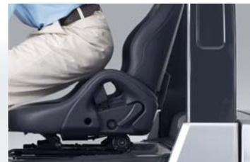
При покидании водителем рабочего места или его неправильной посадке, в то время, когда рычаг переключения направления движения находится не в нейтральном положении, трансмиссия автоматически переходит в нейтральное положение, отключаясь от двигателя.
