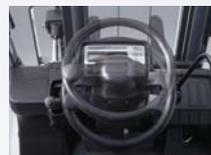
Компактное рулевое колесо с регулируемым углом наклона помогает водителю занять наиболее удобное для работы положение.
