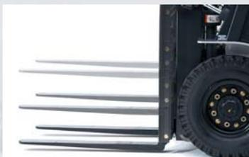
Эта система позволяет избегать ударов о пол, чем предотвращает порчу ценного груза и дорогостоящего полового покрытия.
