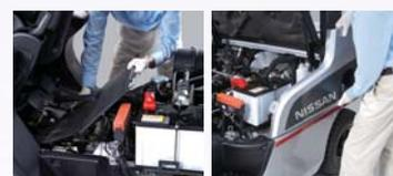
Демонтаж панели пола и боковых панелей производится вручную без использования инструментов, что сокращает время обслуживания и простоев погрузчика.
