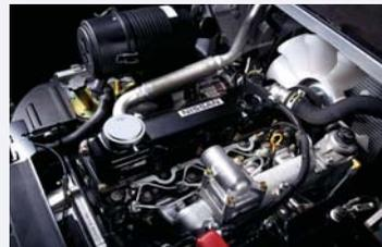
Новый дизельный двигатель QD32 соответствует строгим нормативам содержания токсичных веществ Европейского Союза Stage IIIA и США EPA Tier III. Этот двигатель отлично зарекомендовал себя и доказал высокую надежность, пройдя миллионы километров под капотом коммерческих автомобилей NISSAN. Эти двигатели оборудованы системой быстрого подогрева, которая обеспечивает бесперебойный запуск двигателя в холодную погоду.
