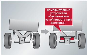
Эксклюзивная разработка NISSAN — система поперечной устойчивости, обеспечивает превосходную управляемость при поворотах погрузчика. Эта система входит в стандартную комплектацию.
