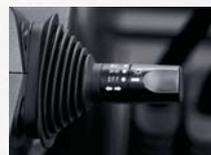
На погрузчиках серии 1F используется переключатель сигнала поворота с конструкцией, заимствованной у автомобилей. Простота управления переключателем позволяет водителю полностью сосредоточиться на работе.
