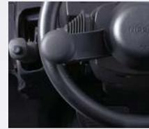
Специальный датчик сверяет положение рулевого механизма с углом поворота колес, таким образом, чтобы после завершения маневра рукоятка руля находилась в исходном положении. Эта функция синхронизирует работу руля и колес, что обеспечивает высокую точность маневрирования.
