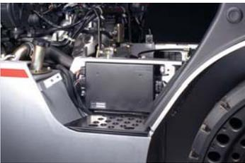
Модуль управления погрузчиком (VCM) использует информацию, получаемую от многочисленных датчиков, и передаваемую через сеть контроллеров (CAN) для последующей обработки и использования при управлении рабочими функциями.
