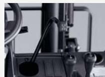
Разработанный конструкторами NISSAN многофункциональный рычаг позволяет совмещать выполнение операций подъема и наклона для увеличения производительности.
