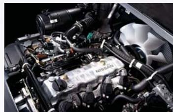
Двигатели с электронной системой впрыска ECCS представляют новое поколение «чистых» двигателей с существенно сниженным, по сравнению с карбюраторными моделями, содержанием примесей CO, HC и NOx в выхлопных газах.
