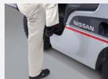
Низко опущенная подножка облегчает водителю подъем и спуск с погрузчика, а поверхность с защитой от скольжения обеспечивает безопасность работы.
