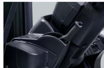
Если водитель покидает погрузчик, не поставив его на стояночный тормоз, раздастся предупредительный сигнал. Данная система, заимствованная у автомобилей, помогает избежать нежелательного движения погрузчика.
