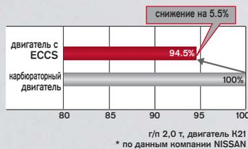
Испытания показали, что, в сравнении с карбюраторными моделями, двигатели с системой ECCS совершают больше полезной работы при том же числе оборотов, увеличивая производительность.
