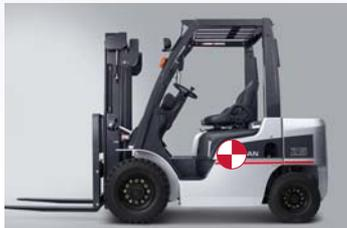
Низко расположенный центр тяжести конструкции обеспечивает погрузчикам серии 1F превосходную устойчивость во время работы. При работе в сложных условиях для еще большего повышения устойчивости могут быть использованы двускатные ведущие колеса.
